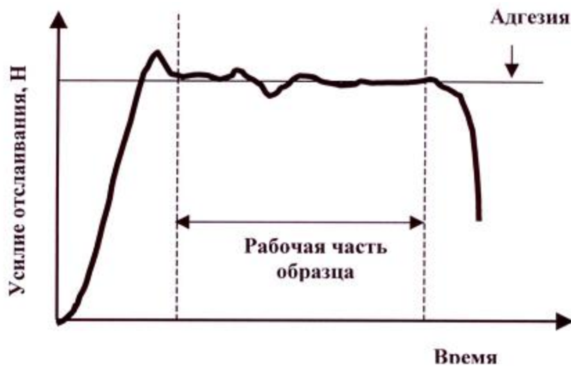
Рисунок 4 - Типичная кривая при проведении испытаний на адгезию
